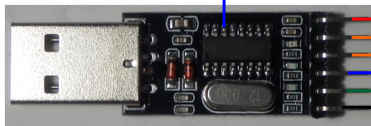
USB-RS232C変換器基板(CH340)
